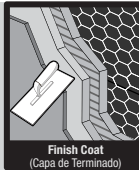
Finish Coat (Capa de Terminado)
