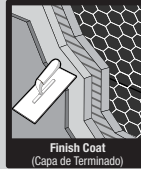
Finish Coat (Capa de Terminado)
